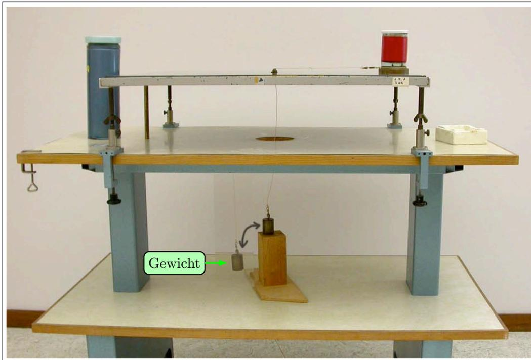
Abbildung 3: Flächensatz zur Zentralbewegung: Verkleinerung des Kreisdurchmessers durch Absenken der Schnur mit einem Gewicht.
